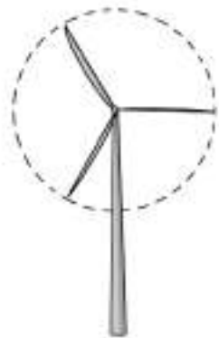
TYPE 1 | NORDEX N117 ashoogte: 134 m rotordiameter: 117 m tiphoogte: 192,5 m vermogen: 3,6 MW energieopbrengst: 12.000 MWh/jaar
