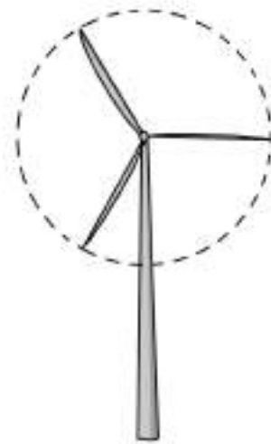
TYPE 2 | VESTAS V172 ashoogte: 175 m rotordiameter: 172 m tiphoogte: 261 m vermogen: 7,2 MW energieopbrengst: 24.000 MWh/jaar
