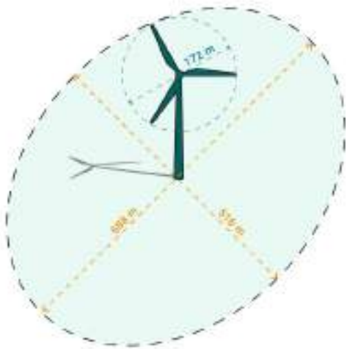
Plaatsingsafstand turbine type 2 (T2)
