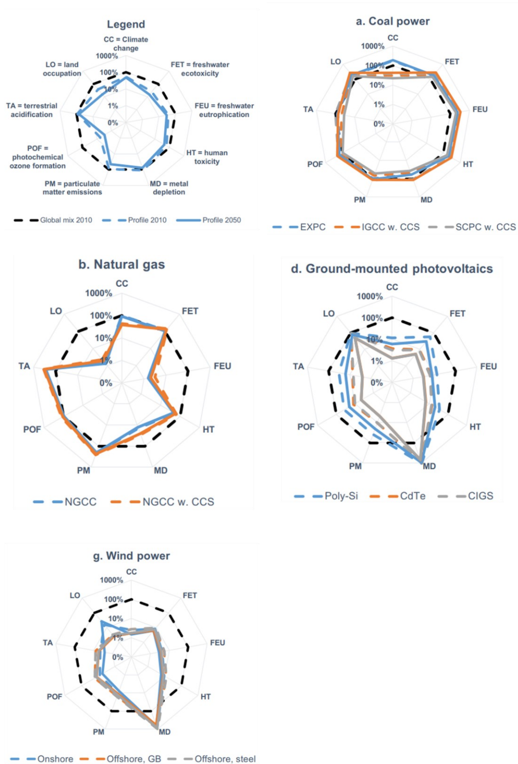
Afbeelding 5.27 Radardiagrammen met de impact op verschillende categorieën van kolen-, gas-, zon-, en windenergie relatief aan het wereldgemiddelde in 2010, aangegeven door de zwarte stippellijn. De verhouding is aangegeven op logaritmische schaal. Het gaat voor alle alternatieven in dit diagram om de blauwe stippellijn (EXPC bij kolen, NGCC bij gas, Poly-Si voor zon, en Onshore voor wind). Bron: (Gibon, Arvesen, & Hertwich, 2017)
