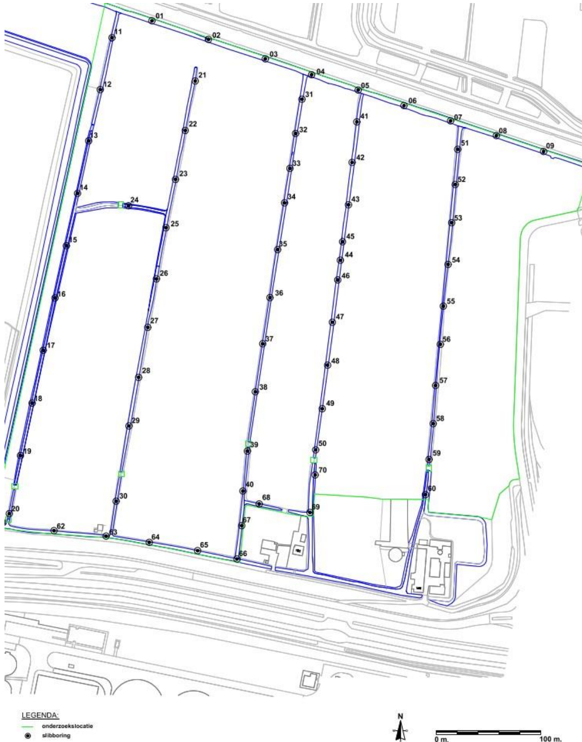
Figuur 11.3 Waterbodemonderzoek tijdens nulsituatieonderzoek (groen: onderzoekslocatie; punten: slibboring) (bron: DIBEC)
