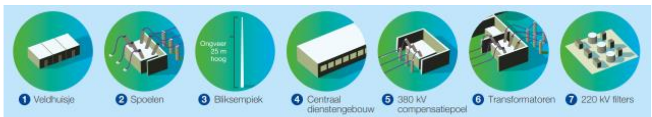
Afbeelding 33. Indicatieve weergave van onderdelen transformatorstation
