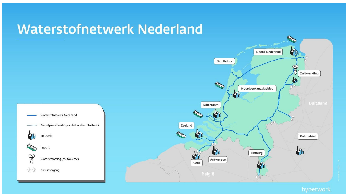
Figuur 2-1 Overzicht van het waterstofnetwerk dat Hynetwork in Nederland gaat aanleggen, met verbindingen naar Duitsland en België.
