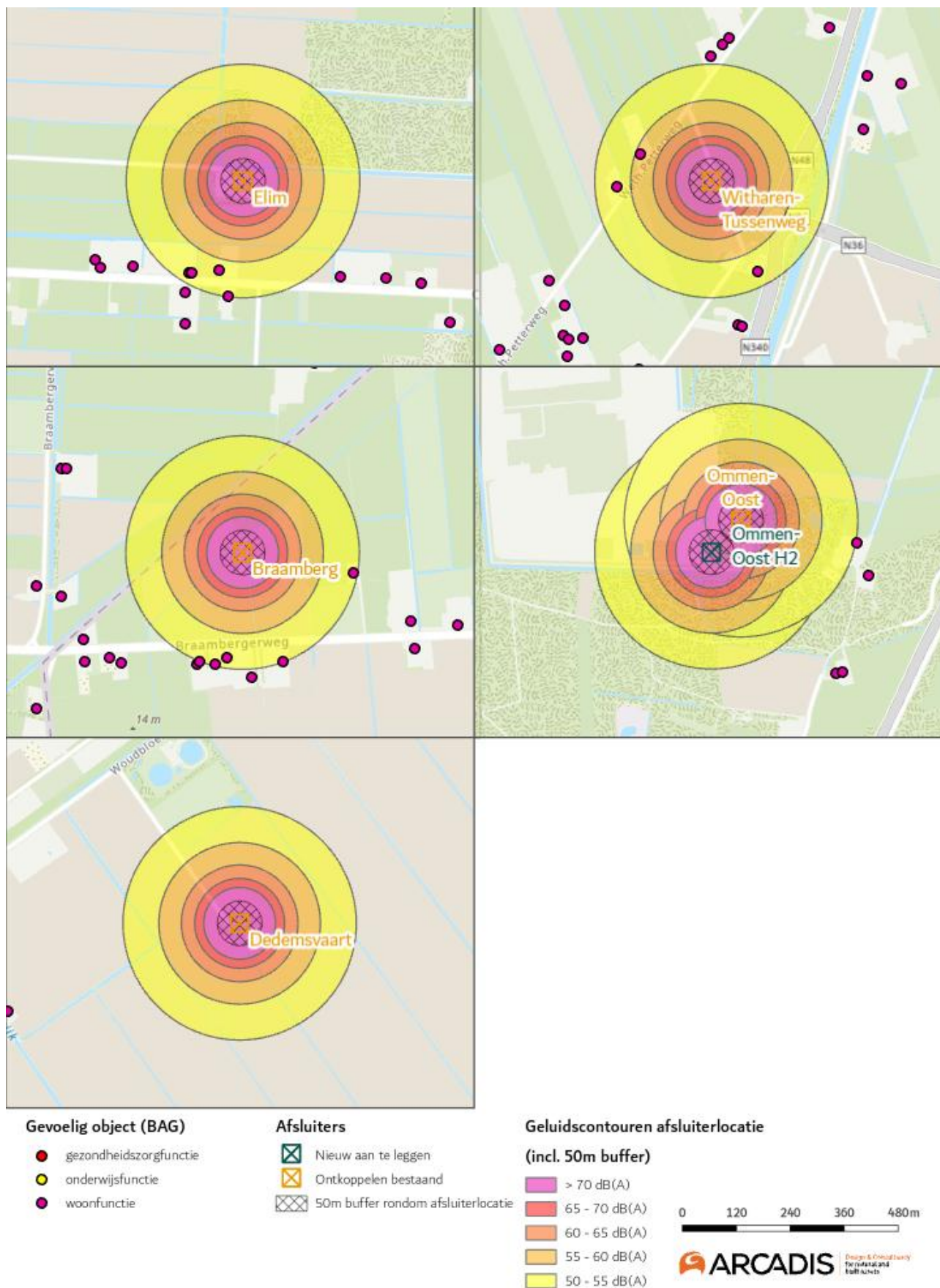
Figuur 3-2 Overzicht ligging geluidscontouren van afsluiterlocaties deelgebied Nieuwediep – Ommen (2)
