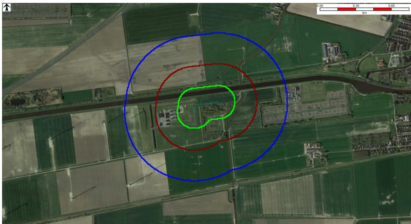
Figuur 8: De warmtestralingscontouren van leiding A-821 KOPPELING.
