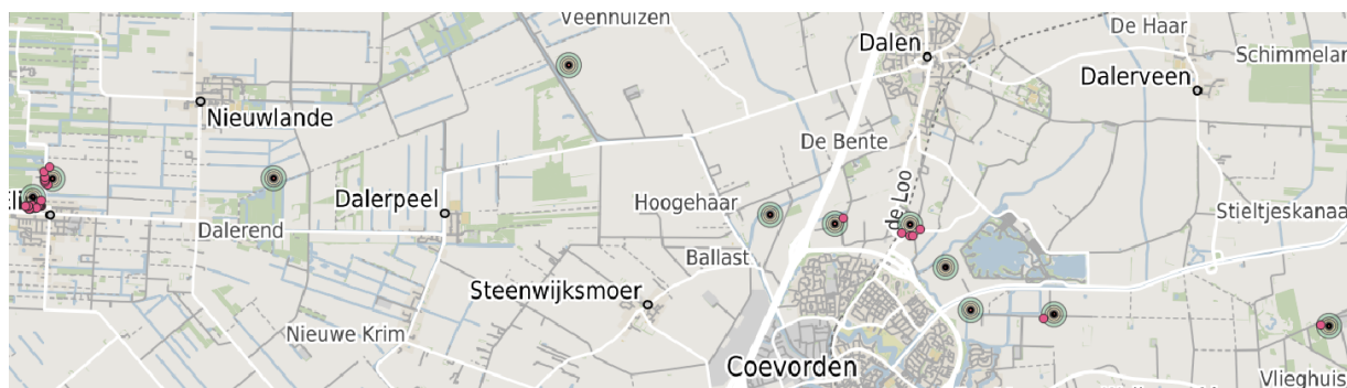
Figuur 13. Overzicht van HDD uittredepunten (met een onzekerheidsmarge van 30 m) met contouren op 20, 30, 60, 90 en 140 meter en woningen (in roze).
