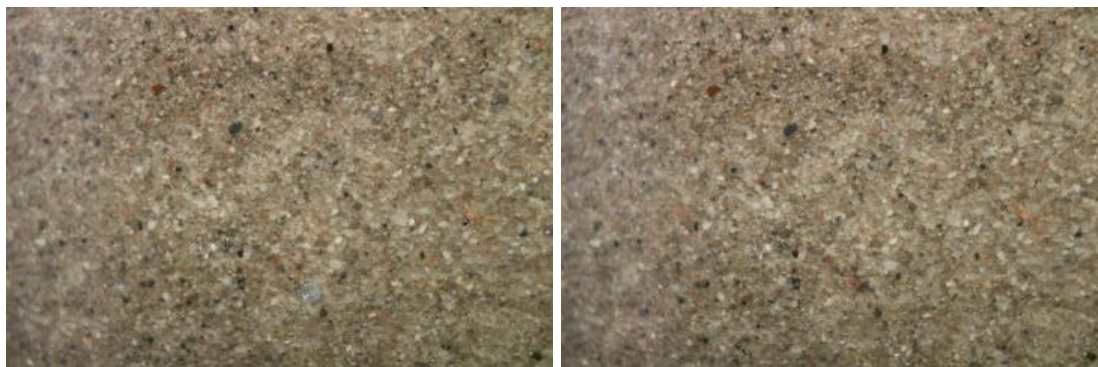
Figuur 0.14 Proef 02 – Foto gezoomd op de korrels aan de onderkant van het monster voor (links) en na (rechts) de proef.
