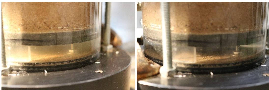
Figuur 0.74 Proef 09 – Foto gezoomd op de korrels aan de onderkant van het monster vóór (links) en na (rechts) de proef.
