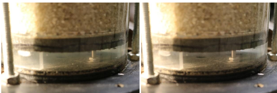
Figuur 0.63 Proef 08 – Foto gezoomd op de korrels aan de onderkant van het monster vóór (links) en na (rechts) de proef.
