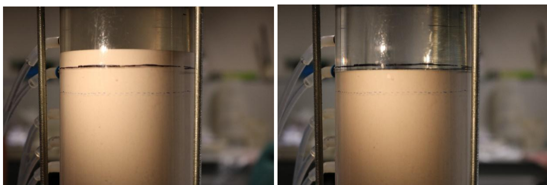
Figuur 3.3 Volume verandering na afloop van proef 8.
