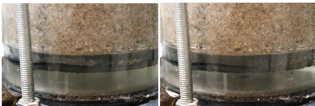
Figuur 0.83 Proef 10 – Foto gezoomd op de korrels aan de onderkant van het monster vóór (links) en na (rechts) de proef.
