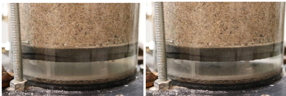
Figuur 0.93 Proef 11 – Foto gezoomd op de korrels aan de onderkant van het monster vóór (links) en na (rechts) de proef.
