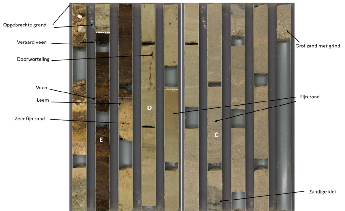
Figuur 3.12 Foto's van boring B01-01 (Pand 20) met daarin de beschreven eenheden (witte letters). Maaiveld (linksboven in boring) is 9,20 m NAP. De kernen zijn 1 m hoog. De bovenste 1,20 m zijn opgebrachte grond. Een aantal opvallende details zijn aangegeven. In Eenheid C is de sterke horizontale afwisseling opvallend met veel sprongen in korrelgrootte. De algemene trend is een verfijning naar boven. Eenheid D bevat regelmatig leemlaagjes verspreid over de dikte. De doorworteling in deze eenheid komt vanuit het veenniveau erboven. Het veen in Eenheid E is onderin voedselrijk en wordt naar boven toe voedselarm. De top is veraard
