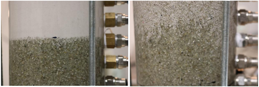
Figuur 0.64 Proef 08 – Foto van de scheiding tussen grof en fijn vóór (links) en na (rechts) de proef. De camera is naar beneden geschoven na 3 dagen en 18 uur om de onderkant van de infiltratie te zien.
