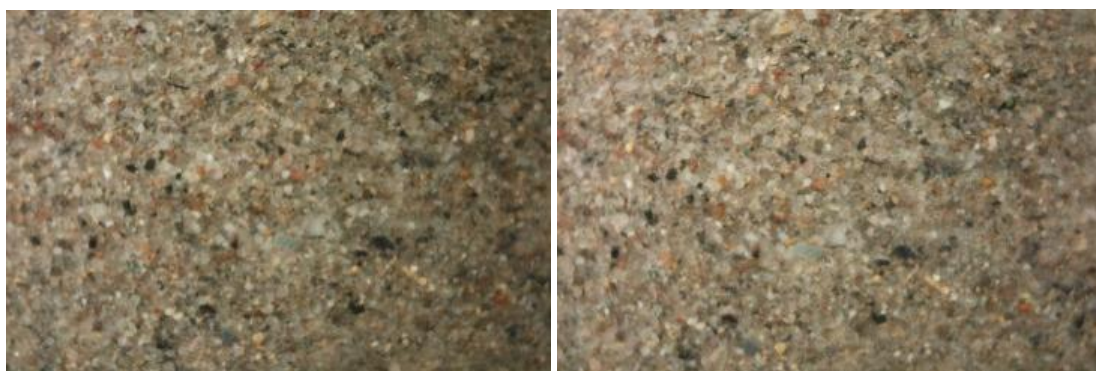
Figuur 0.5 Proef 01 – Foto gezoomd op de korrels aan de onderkant van het monster voor (links) en na (rechts) de proef.
