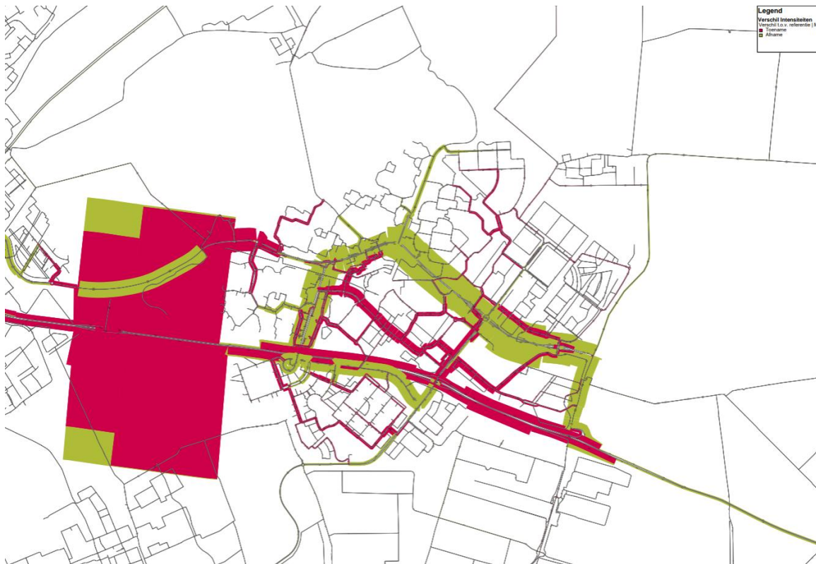
Figuur 6.1: te verwachten verkeersintensiteiten, verschil tussen alternatief 1 en de referentiesituatie. Hoe breder de lijn, hoe groter de verwachte toename.
