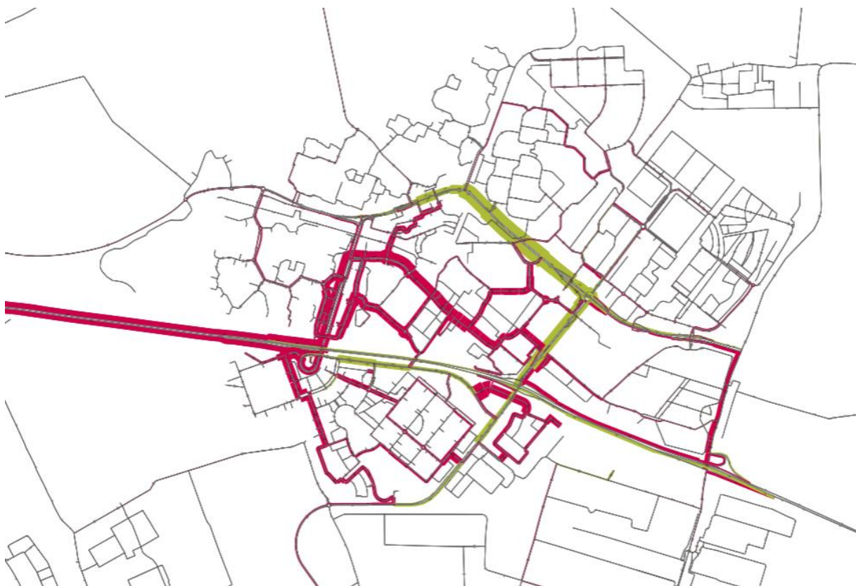
Figuur 6.3: te verwachten verkeersintensiteiten, verschil tussen alternatief 3 en de referentiesituatie. Hoe breder de lijn, hoe groter de verwachte toename.
