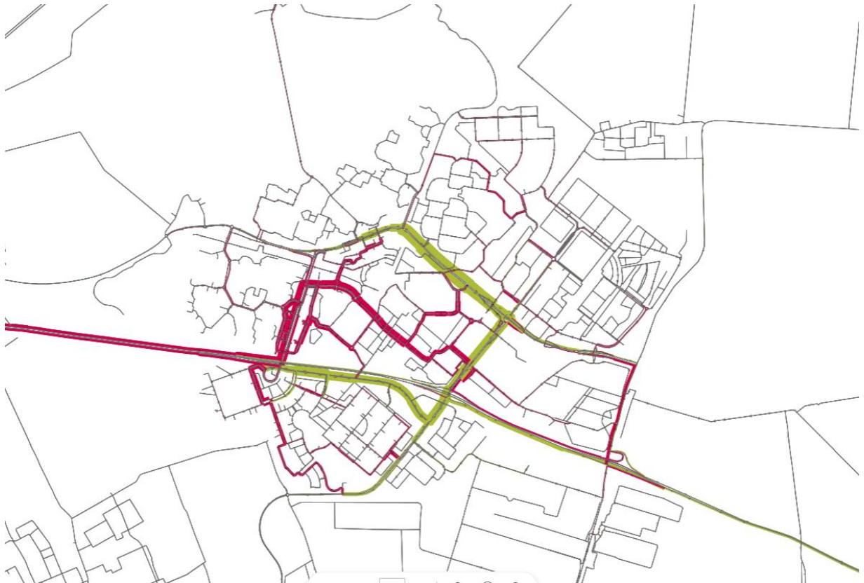
Figuur 6.2: Te verwachten verkeersintensiteiten, verschil tussen alternatief 2 en de referentiesituatie. Hoe breder de lijn, hoe groter de verwachte toename.
