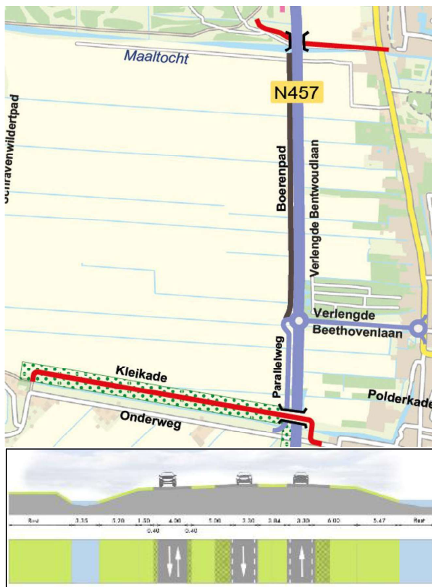
Figuur 3.13 Ligging van de parallelweg en doorsnede Verlengde Bentwoudlaan en openbare parallelweg
