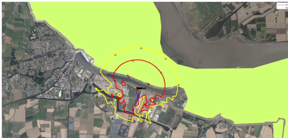
Figuur 4.3 Indicatieve geluidcontouren bij heien betonnen prefab palen (6 heistellingen gelijktijdig)
