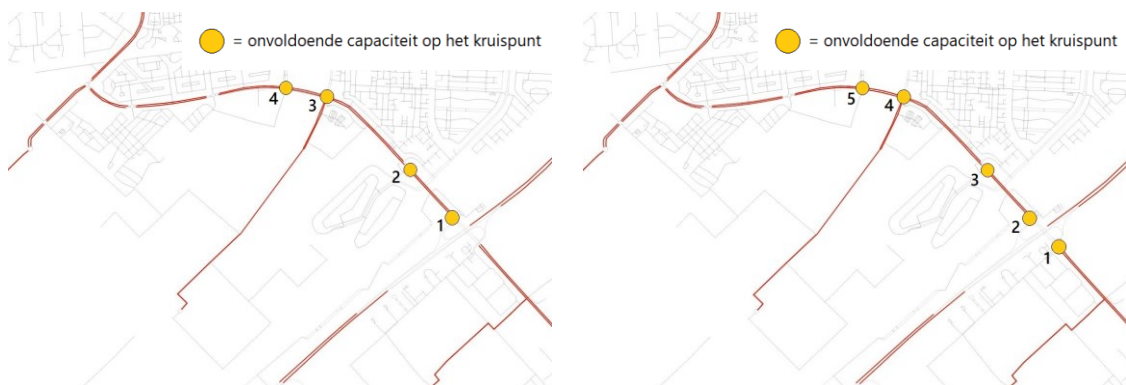
Afbeelding 4.2 Kruispuntenanalyse referentiesituatie 2040 Hoog in de ochtendspits (links) en avondspits (rechts)
