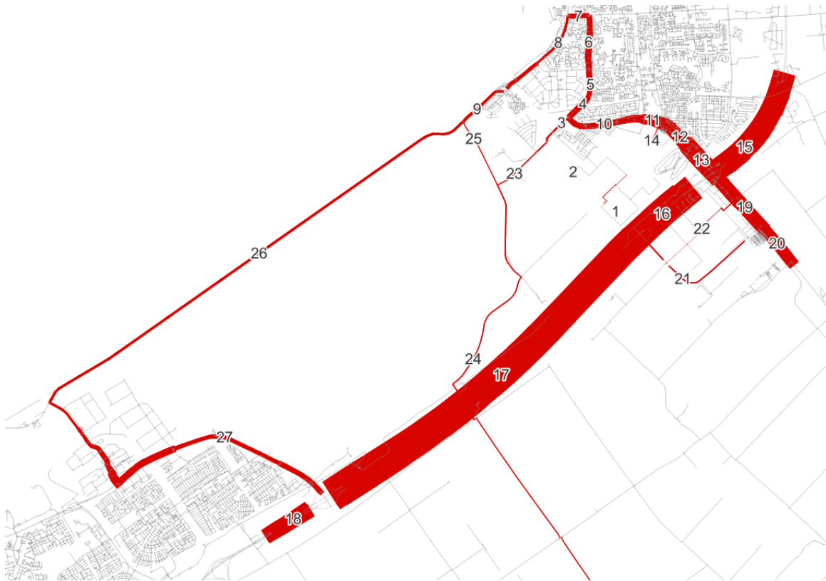
Afbeelding 4.4 Etmaalintensiteiten (per wegvak, zie tabel 4.3 voor de nummering) referentiesituatie 2040 Hoog, lijndikte hoger op wegvakken met hoge verkeersintensiteiten (dikker bij hogere verkeersintensiteiten)
