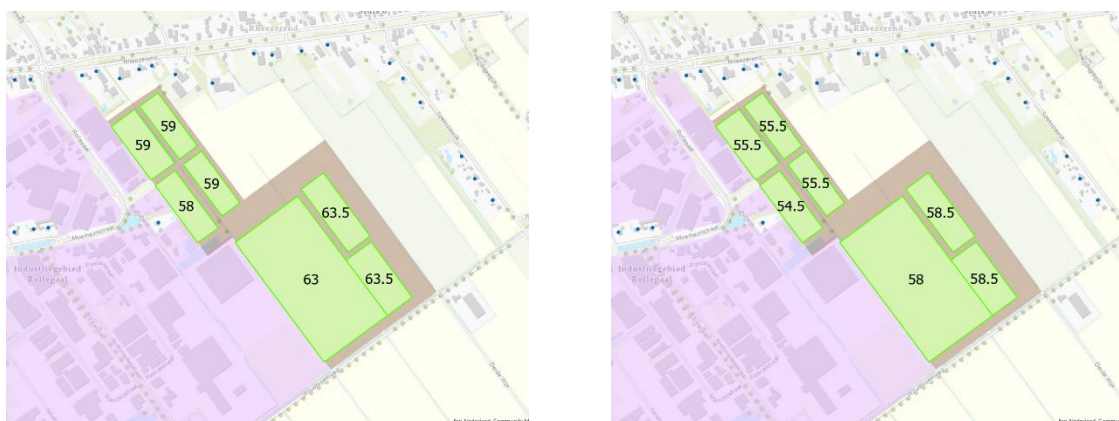
figuur 7: inpasbare reserveringen geluidruimte in dB(A)/m 2 - links zonder toekomstruimte, rechts met toekomstruimte
