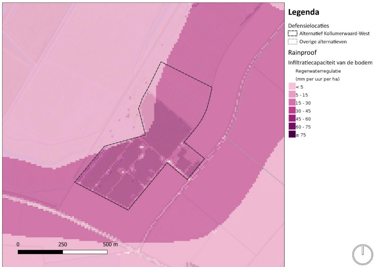
figuur 9-24: Infiltratie in mm per uur per ha – locatie Kollumerwaard-West
