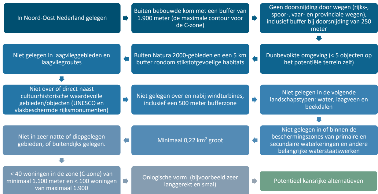
Figuur 2-1 Stroomschema van de stappen in de GIS-analyse hoe met behulp van de genoemde selectiecriteria tot de uiteindelijk acht potentieel kansrijke alternatieven is gekomen.
