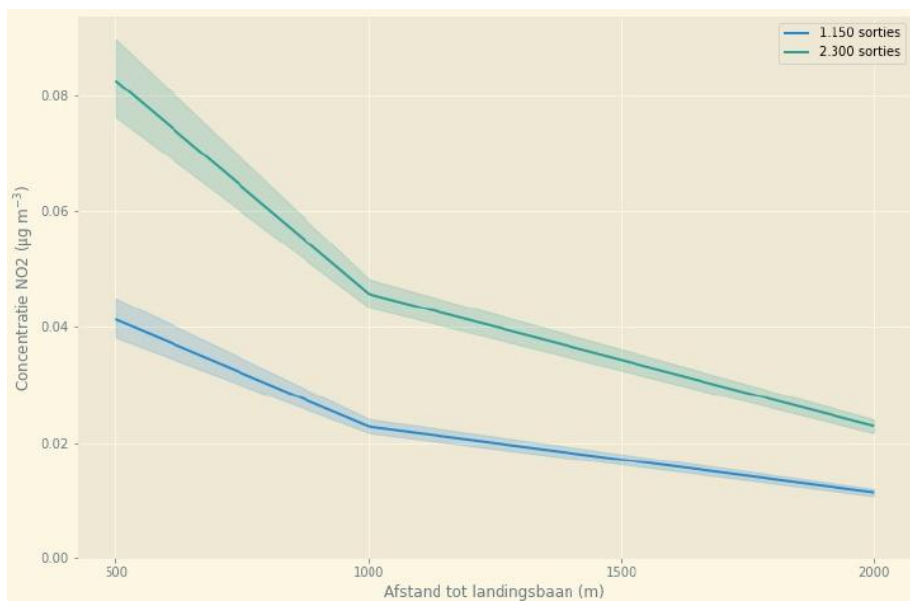
figuur 3-11 Bijdrage van de hele en halve behoefte aan concentraties stikstofdioxide ten opzichte van de afstand tot de landingsbaan
